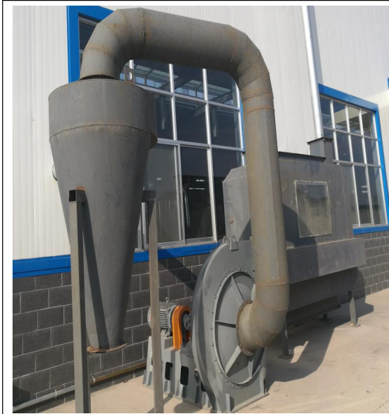
底漆、面漆喷涂旋风除尘+过滤棉+活性炭
