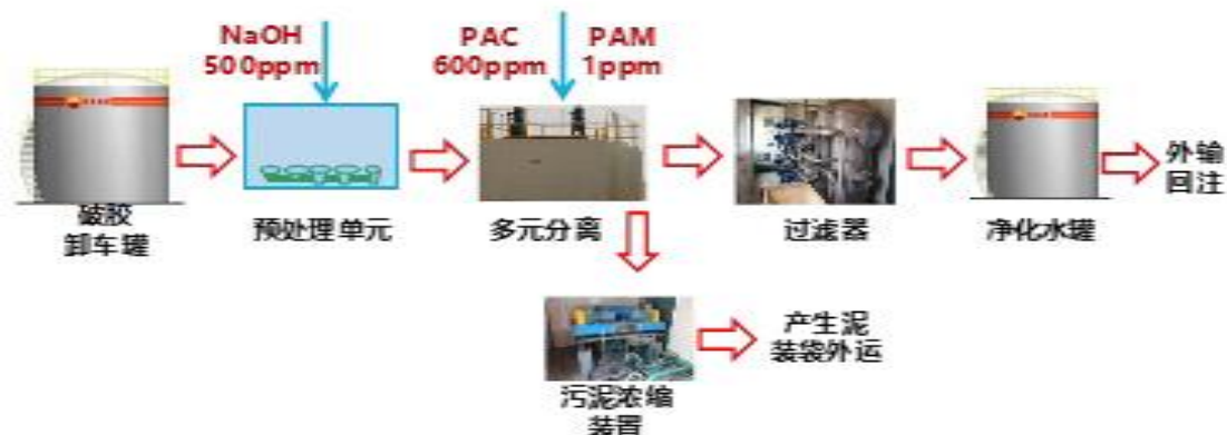
图 7.2-1 采出水处理站处理工艺流程图
