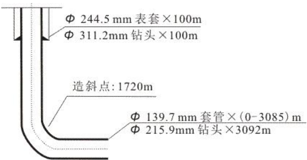
图 4.7.2-3 水平井井身结构图 本项目各类井型参数数量明细表
