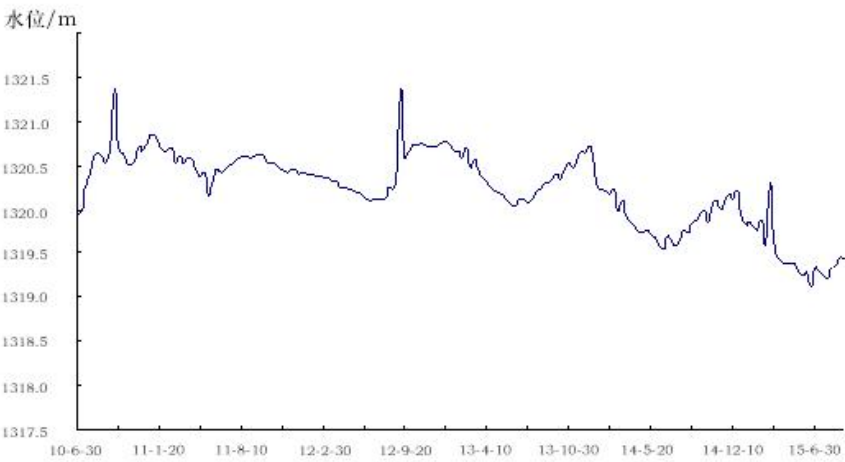
图 9.3.5-3 黄土塬区 GG19 号孔黄土潜水水位动态曲线
